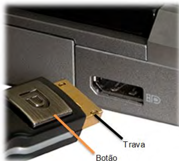
Figura 20 – Conector DisplayPort para computador mostrando o mecanismo de trava e o botão de liberação
